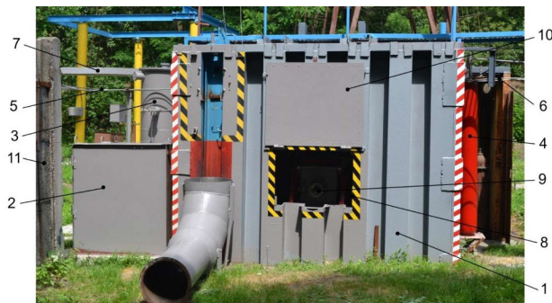
Рис. 1. Стенд вогневих випробувань детонаційних ракетних двигунів: 1 – бронекамера; 2 – повітряний компресор; 3 – ресивер повітря; 4 – ресивер пального; 5 – трубопроводи подачі газів від балонної батареї окислювача; 6 – трубопроводи подачі газів від балонної батареї пального; 7 – естакада для електрокабелів; 8 – вікно; 9 – об'єкт випробувань; 10 – кришка вікна; 11 – захисна стіна
